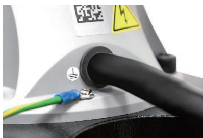
图 24：固定地线和机器人
